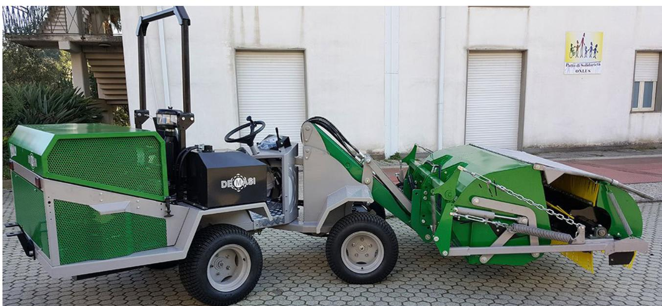
**Impianto idraulico:** trasmissione con pompa a portata variabile e motori idraulici indipendenti per ogni singola ruota; sterzo idraulico con impianto e pompa indipendente; servizi ausiliari con impianti e pompa indipendenti, con attacchi rapidi frontali, multiuso.
